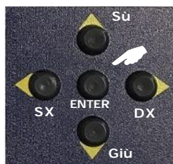
Grupo de botones de navegación . Estos botones se utilizan para configurar el funcionamiento de la centralita.
