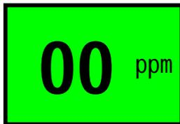
Display con color **Verde**, representa una ausencia de detección de gas. Condición normal
