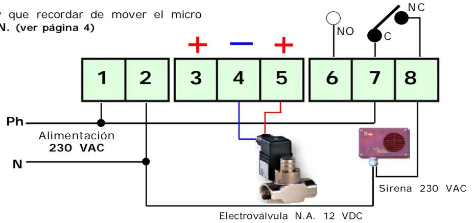
**Alimentación 230 VAC con conexión electroválvula N.C. alimentada a 12 VDC por la ayuda de una batería; seguridad positiva desconectada.**
