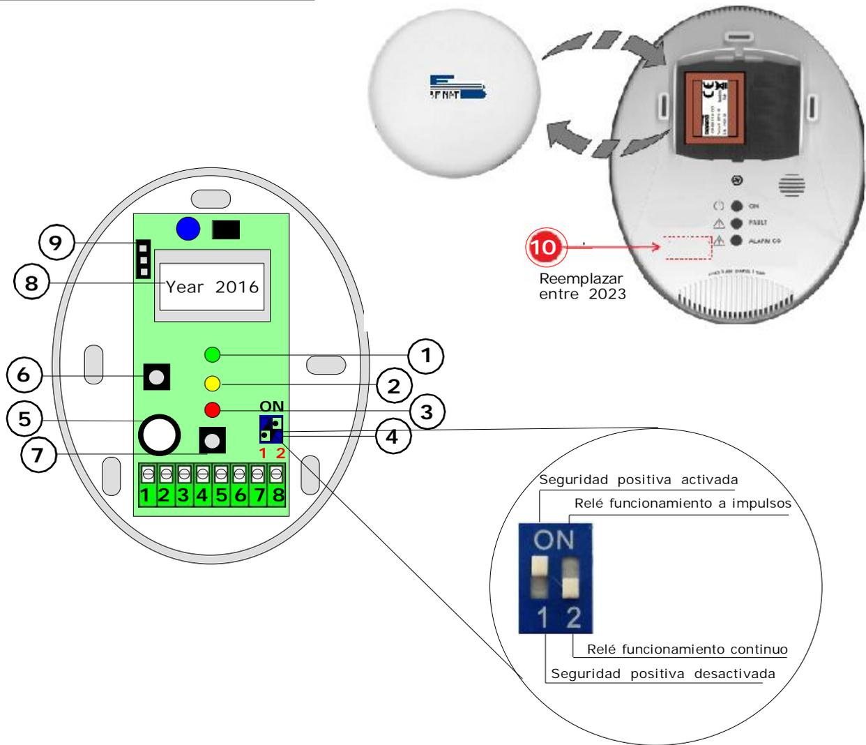
**1)** Led de señal de red. Cuando el LED **verde** parpadea, el **GS920** está realizando el auto control de la eficiencia del sensor y lo llevara a la temperatura de trabajo. Esta fase dura unos 60 segundos, al término de lo cual, el led dejará de parpadear, y quedará la luz verde fija.
