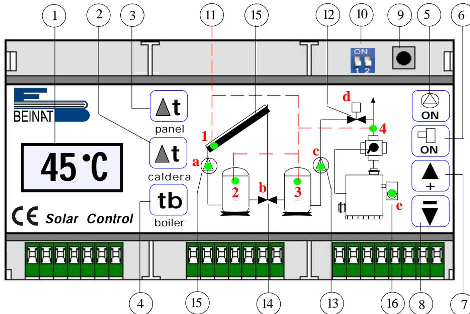
**1) Pantalla.** Se utiliza para ver todos los eventos necesarios para la programación por parte del usuario, tanto para leer las temperaturas detectadas por las sondas.
