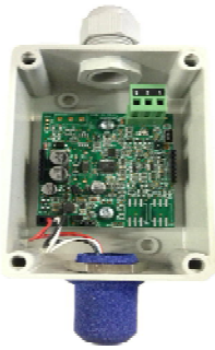
Sonda con sensor a reemplazar
