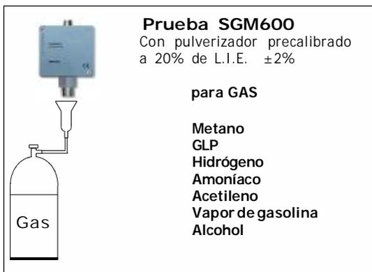
La instalación de la sonda **SGM600** u mantenimiento ordinario, extraordinario y la puesta fuera de servicio de la sonda al finalizar el periodo de funcionamiento garantizado por el constructor, deberá ser realizada por personal autorizado o especializado.
