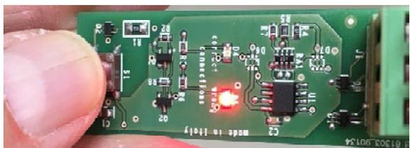
3) Después de insertarlo, mantener presionado. Si el **LED rojo** se enciende Significa que la conexión de los cables es **INCORRECTA**. Verifique la conexión y vuelva a intentarlo. La unidad de control no informa ningún estado de ALARMA, pero indica el estado de AVERÍA.
