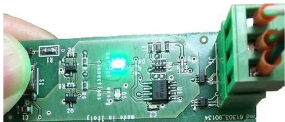
2) Después de insertarlo, mantener presionado el botón. Si el **LED verde** se enciende. Significa que la conexión de los cables es **EXACTA**. Al mismo tiempo, la unidad de control saldrá del estado de Avaria y señalará el estado de ALARMA.
