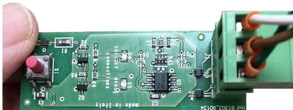
1) Insertar el terminal del cable de la sonda proveniente de la centralita en el CHECKER-24, como se muestra en la figura.
