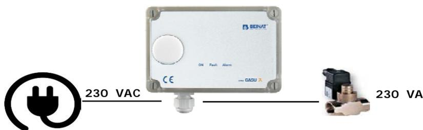
El **GASU** mediante del sensor **catalítico**, detecta la presencia de gas explosivo, como **Metano y GLP** con un margen de intervención medida al 10% del **LIE**, y puede accionar mediante el relé incorporado, electroválvulas, sirenas y cualquier otro aparato de señalización o alarma.
