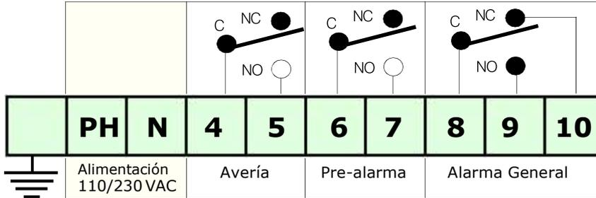
El bloque de terminales de señal (figura anterior) se compone de la siguiente manera:
