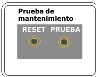
La pulsación simultánea y prolongada de las teclas "**RESET**" y "**PRUEBA**" durante 5 segundos habilita el modo de mantenimiento.
