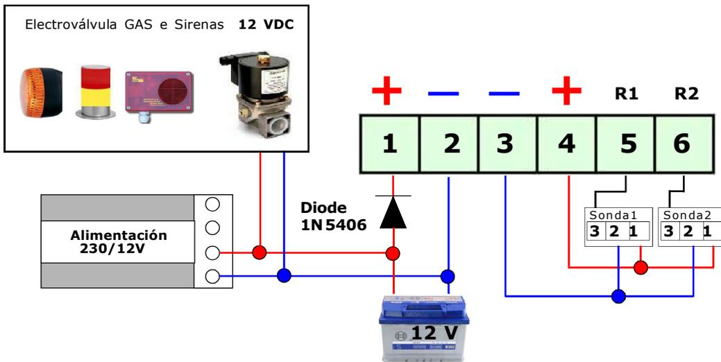
Si una válvula solenoide de 12 VDC, que no funciona bien, está conectada a la BX280-AX.
