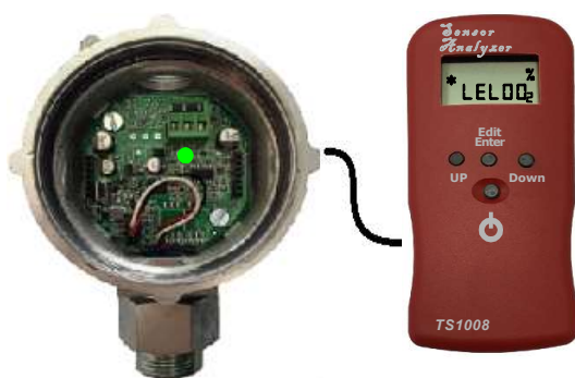
En ausencia de gas se lee 0% de Gas
