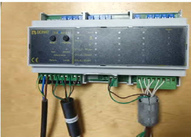
Instalar ferritas en el cable de señal y salidas de relé según certificado FTZU 23 0078 X. Ver foto
